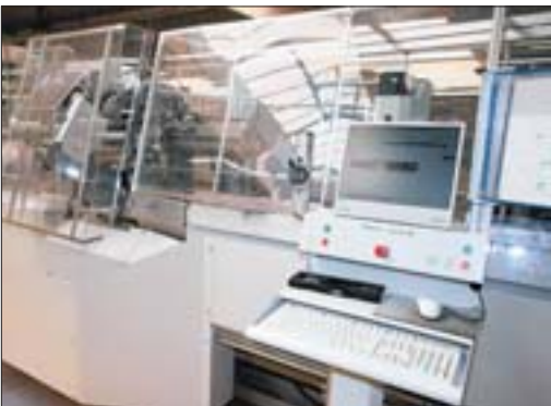
Moderne Kabelbearbeitungsmaschinen fertigen die Kabelbäume für die Audi Klimaanlage.
